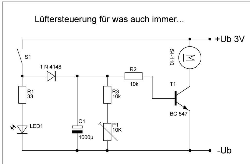
Nach dem Einschalten mit S-1 leuchtet die LED und der Lüftermotor arbeitet. Nach dem Ausschalten geht die LED aus, der Lüftermotor arbeitet aber noch ca. 5 - 10 Sekunden. Diese Verzögerungszeit kann mit P-1 eingestellt werden.
