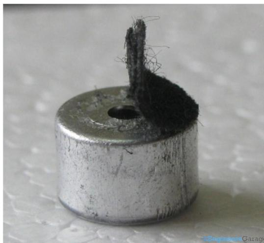
Ein festes leitendes Metallgehäuse umschließt die verschiedenen Komponenten des Mikrofons. Die Oberseite ist mit einem durchlässigen Material beklebt, das als
